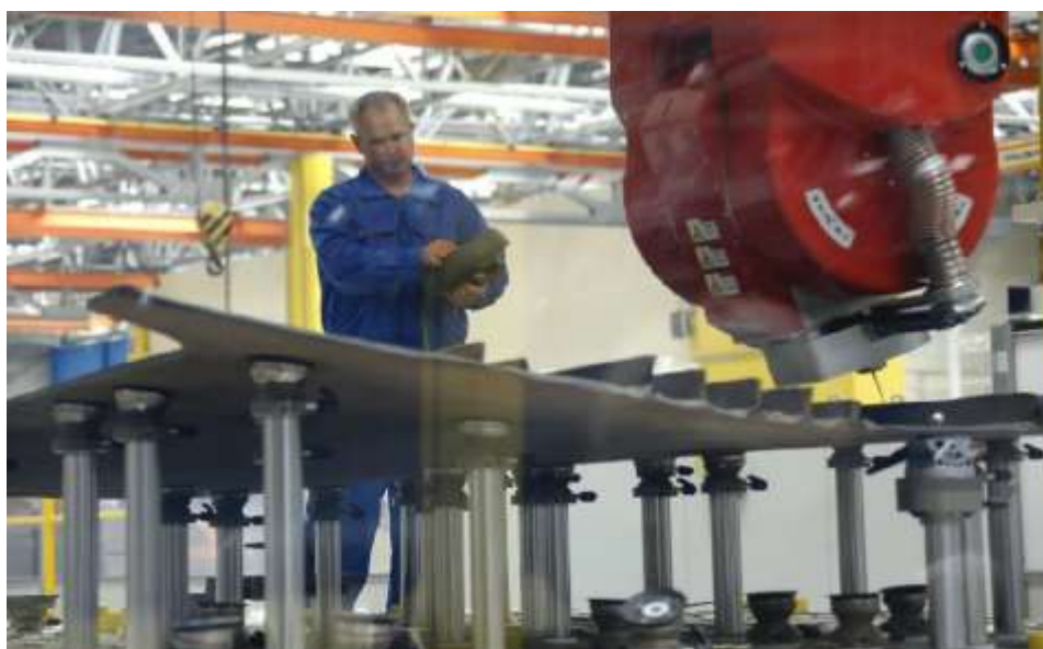
Рисунок 37 - Фрезерование на гибком столе (вакуумных актуаторах)
