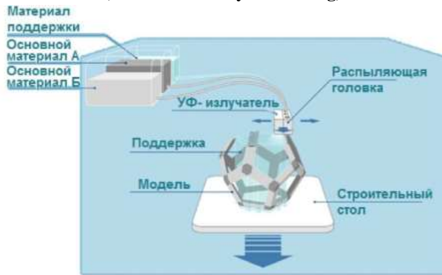
Рисунок 47 – Схема процесса PPJ
