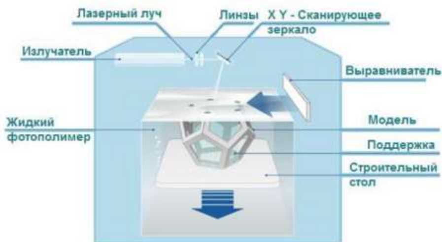
Рисунок 47 – Схема процесса SL
