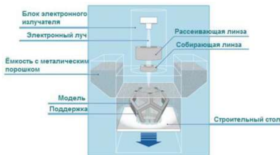
Рисунок 43 – Схема процесса EBM
