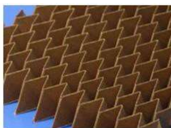
Образец наполнителя типа z-гофр из органопластика
