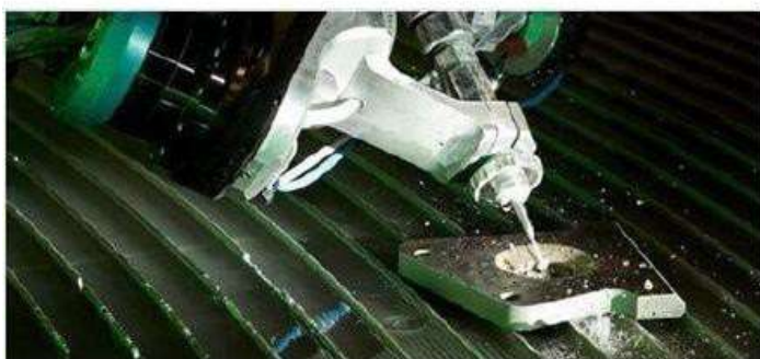
Рисунок 38 – Схема установки для гидроабразивной резки
