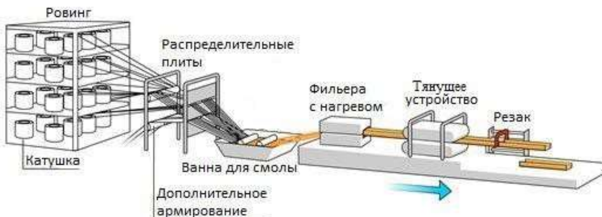
Рисунок 28 – Схема процесса пултрузии
